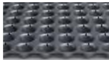
Maxistud F ist eine Noppenbahn aus hochdichtem Polyethylen (HDPE) mit 20mm Stärke und einer Wasserspeicherkapazität von ca. 5,8 l/m<sup>2</sup> zur Verwendung in Dachgärten. Die Löcher im oberen Teil ermöglichen die vertikale Ableitung von überschüssigem Wasser. Die horizontale Ableitungskapazität beträgt 2,50 l/m\*s.
