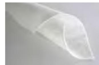
Geotextilvlies mit 300 g/m<sup>2</sup> aus weißen recycelten Polyesterfasern. Trennfunktion zwischen der Ansammlungs- und der Drainageschicht und der Abdichtung, um diese noch besser zu schützen.
