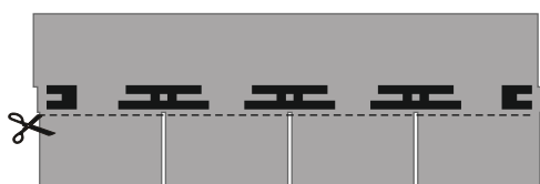
Abb. 2 - Abschneiden der Zungen
