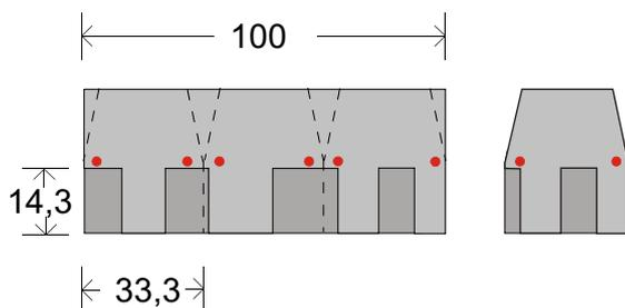
Abb. 6 - Schneiden der Schindeln für den First
